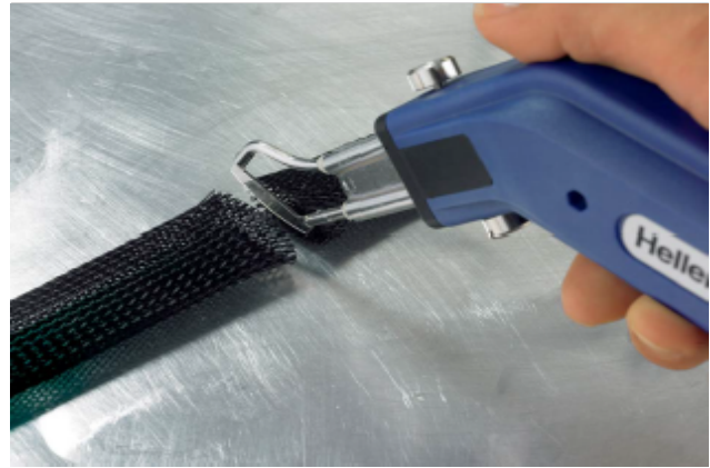
Uitrafelen bij het doorsnijden van een gevlochten kous kan met de HSG0 worden vermeden.
